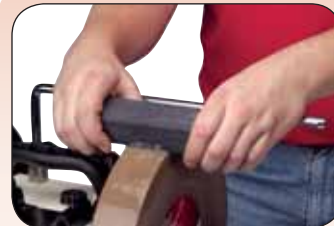
Артикул 708017* Брусок для очистки шлифовального круга Два вида зернистости для преобразования зерна шлифовального круга и исправления поверхности
