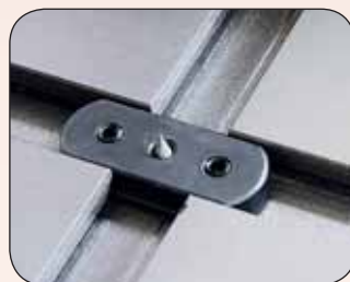
Приспособление для шлифования заготовок по кругу
