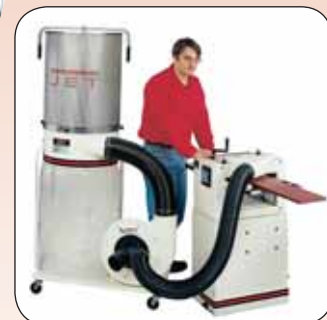
Присоединение вытяжной установки к станку JPM-13CST
