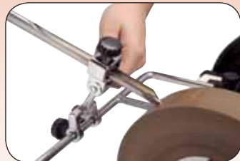
Артикул 708020 Приспособление для заточки овальных стамесок. Применяется для доводки конусных и полукруглых стамесок.
