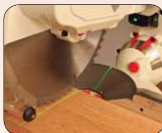
Световой указатель зеленого цвета места распила на заготовке
