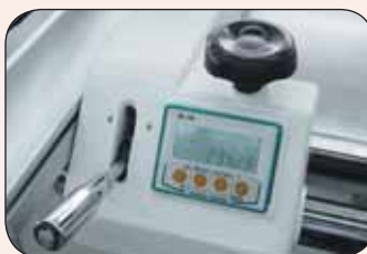
К параллельному упору - цифровая индикация в качестве принадлежности
