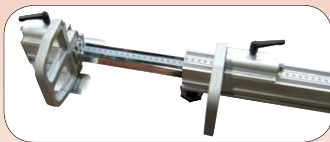
Выдвижной торцевой упор с откидываемыми концевыми ограничителями
