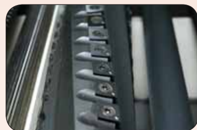
Строгальный вал «helical»
