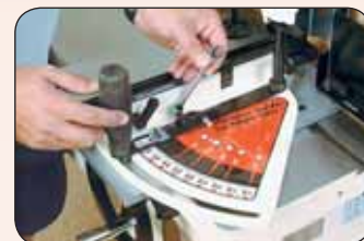
Поворотный упор для точного пиления под углом 0° / 90° / 135°
