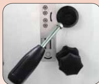
Рукоятка для быстрого натяжения полотна пилы
