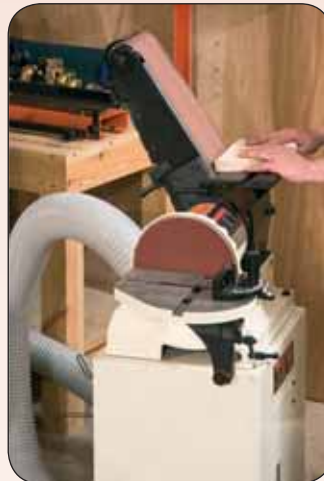
Стол из серого чугуна, плавно регулируемый от 90° до 45°
