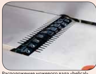
Расположение ножевого вала «helical»
