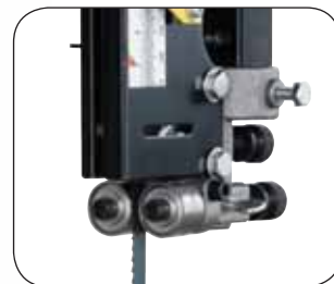
Узел регулирования установки пильной ленты JWBS-14Q
