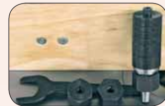
Шпиндель и цанги 8 или 12 мм
