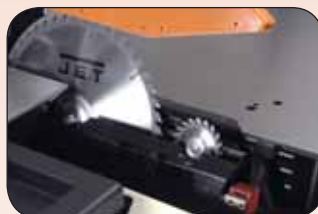
Расположение основного и подрезного пильного диска
