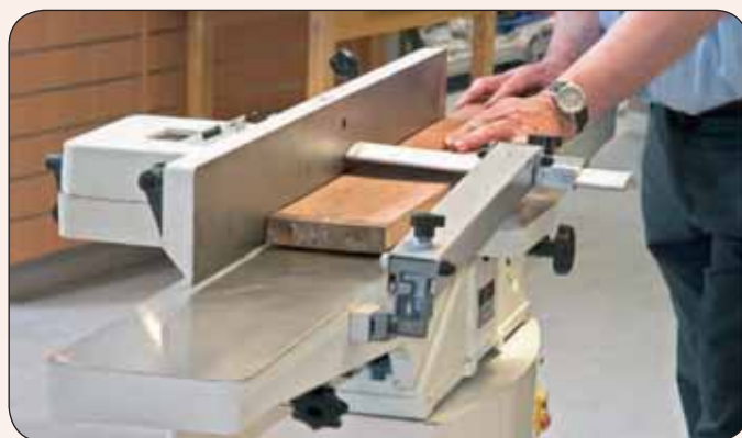
Ручки регулирования наклона и блок перемещения упора по ширине плоскости стола
