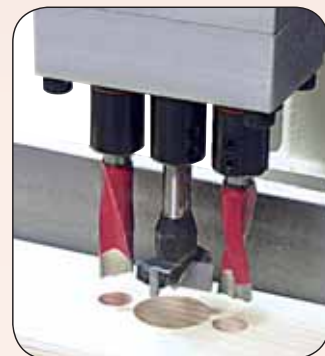
Артикул 10003350 Сверлильная голова 43 мм Для выборки пазов в оконных рамах Расстояние между шпинделями 2x21,5, включая инструмент из твёрдого металла Ø12 / Ø26 / Ø12 мм
