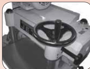
Штурвал подъёма строгальной головы
