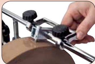
Артикул 708018 Алмазное приспособление применяется для правки шлифовального круга
