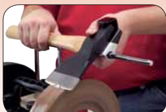
Артикул 708031 Приспособление для заточки топоров Применяется для доводки топоров
