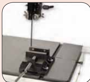
Возможность установки тисков, используя Т-образный паз чугунного стола
