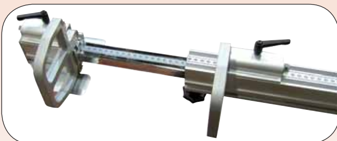
Выдвижной торцевой упор с откидываемыми концевыми ограничителями
