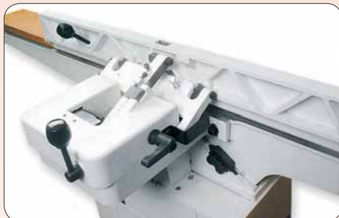
Ручки регулирования наклона и блок перемещения упора по ширине плоскости стола
