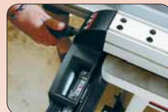
Запатентованный параллельный упор Micro-Glide со встроенным увеличительным стеклом и точной регулировкой по шкале обеспечивает точность установки пильного размера до 0,1 мм
