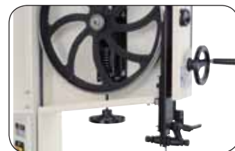
JWBS-16X / 18Q Точно настраиваемая прецизионная направляющая
