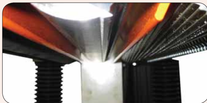
Ножевой вал, приводные валы
