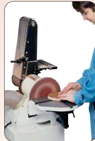
Стол из серого чугуна, плавно регулируемый от 90° до 45°
