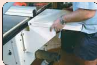
Удлинение стола сзади (Стандартная комплектация) легко снимаемое
