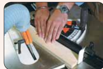
Возможно пиление острых углов со стандартно поставленным упором для точного пиления
